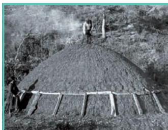
Pila carbonera: Apilament de fusta per coure-la a 700 °C.
