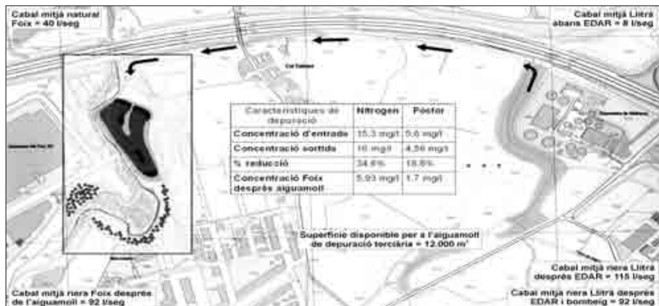
Figura 4. Aiguamoll de depuració terciària i dades del bombament.
