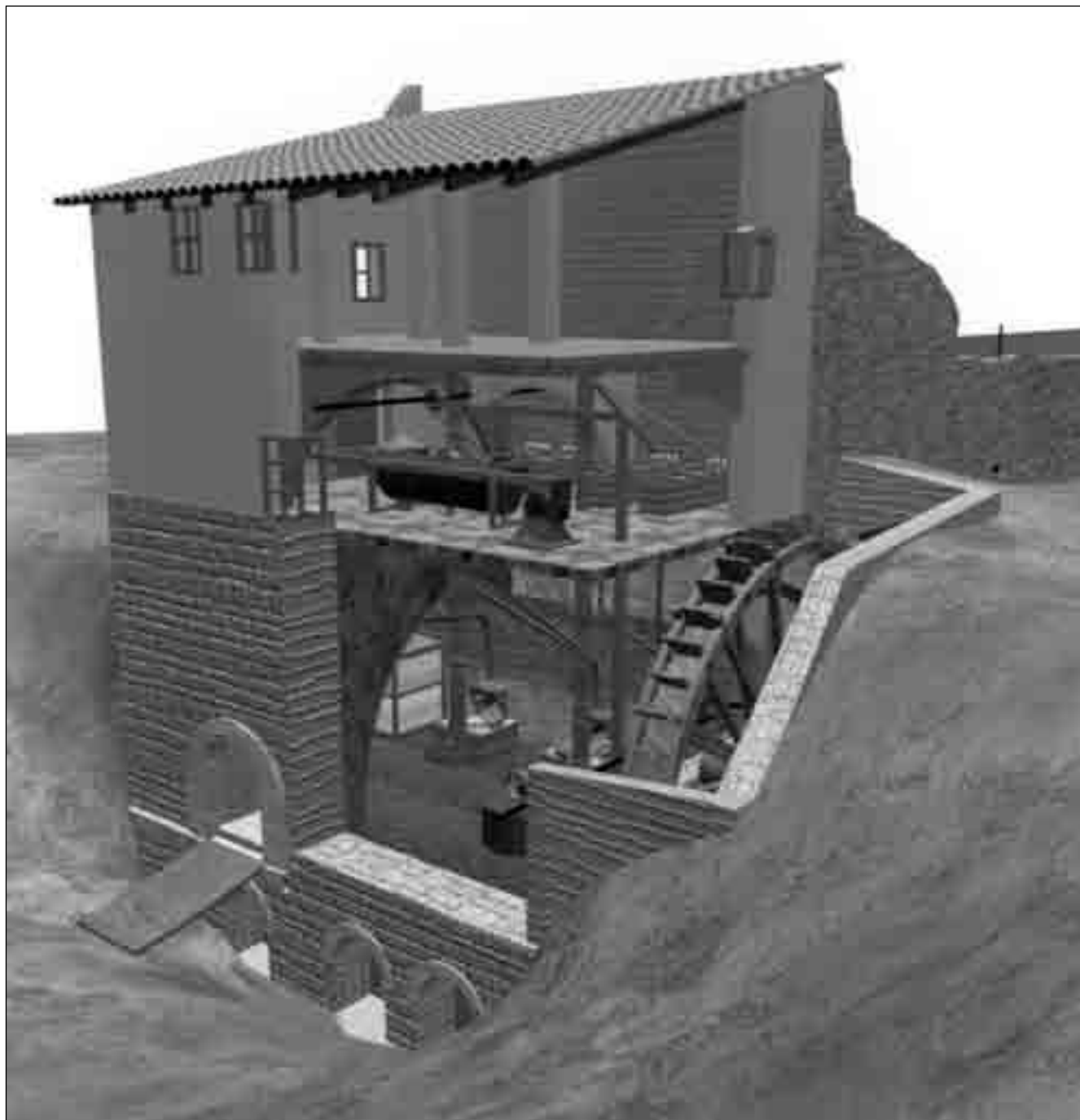
Figura 4. Reconstrucció virtual del molí del Foix amb la roda vertical i la farinera.
