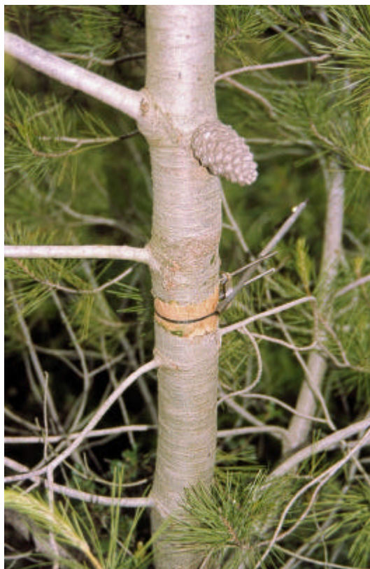
Figura 3. Dendròmetre de banda instal·lat en un pi blanc del Garraf per mesurar els increments en el perímetre del tronc. (Fotografia: Montserrat Ribas, 2002).
