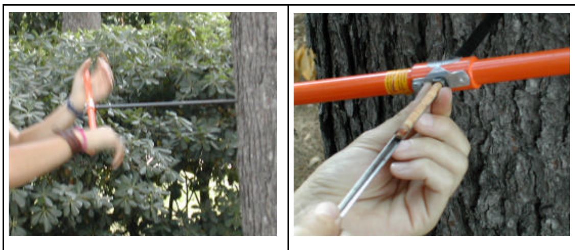
Figura 4. Extracció d'un testimoni de fusta mitjançant l'ús d'una barrina Pressler.
