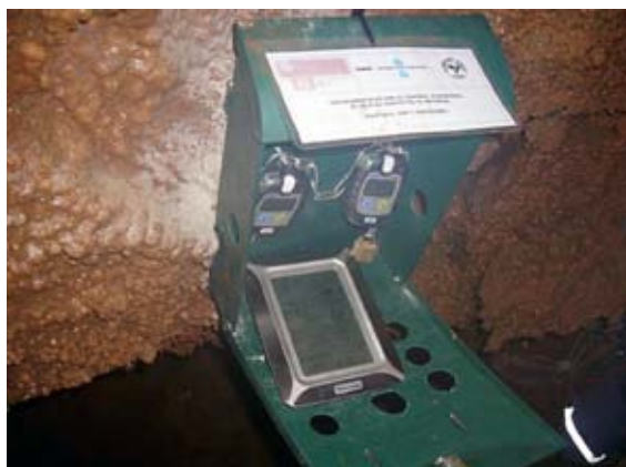
Foto 3. Estació a -50 m: detectors de O_2 , CO_2 i estació meteorològica.
