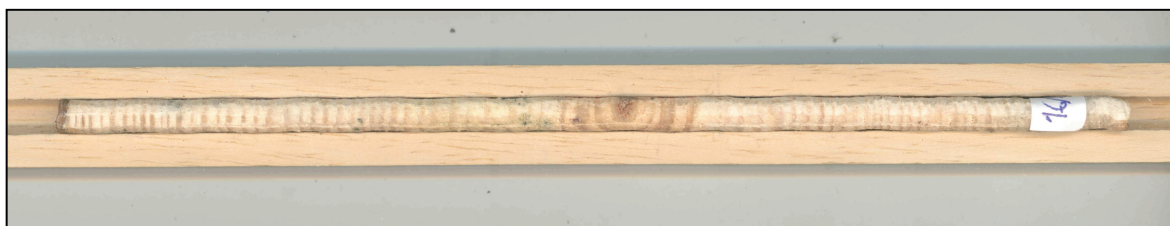
Fig. 3.4: Testimoni de fusta fixat a un llistó i amb la superfície de lectura llimada. Els anells de creixement es distingeixen nítidament. (Fotografia: Laura Farré).
