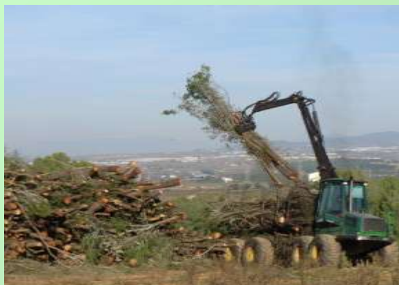
Desembosc de fusta amb autocarregador
