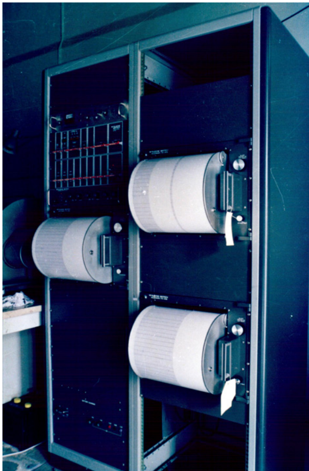
Figura 1. Sistema Teledyne de captació de les dades dels sensors Geotech S-13 via ràdio, desmodulació i registre analògic en bandes sísmiques de paper i tinta, al seu emplaçament des d'inicis dels anys vuitanta
