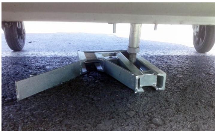
Figura 9.4. Sistema d'ancoratge del contenidor a la plataforma antibolcada de la seva base.
