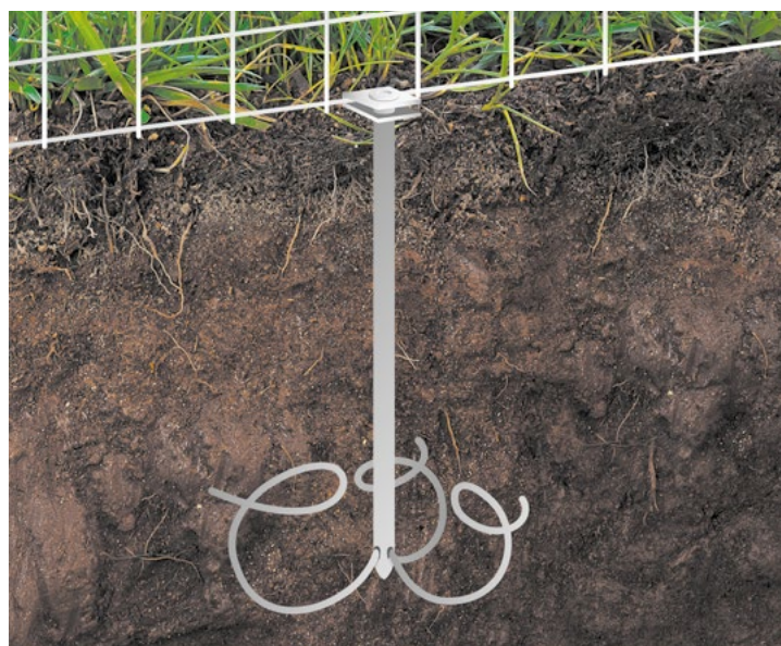
Figura 2.5. Piqueta per ancoratge de la malla al terreny.
